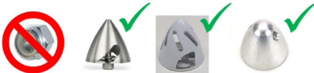
Figura 3.2: Dispositivos permitidos y prohibidos para asegurar la hélice
