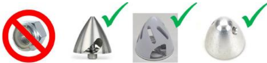
Figura. Dispositivos permitidos y prohibidos para asegurar la hélice.
